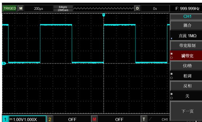
图 5-2 直流耦合时信号的直流分量和交流分量同时被显示
