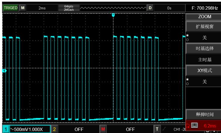
图 7-4 使用触发释抑同步复杂波形
