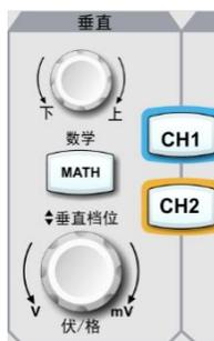
图 4-6 面板上的垂直控制区
