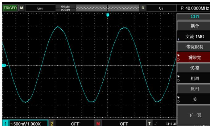
图 5-4 带宽限制关闭时的波形显示
