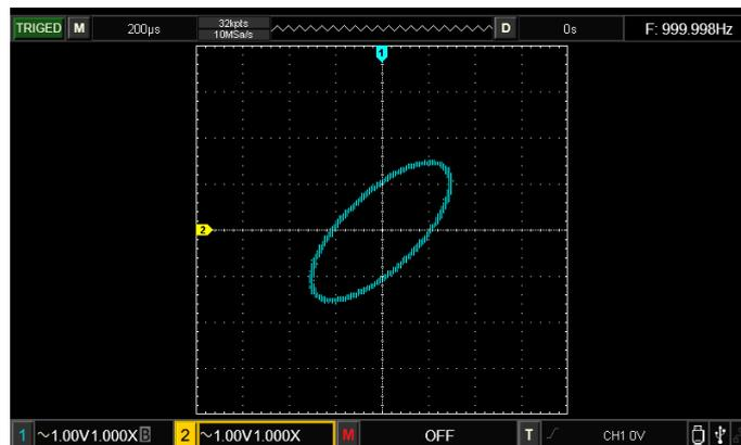
图 6-5 XY 方式下的波形显示
