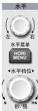
图 4-7 面板上的水平控制区
