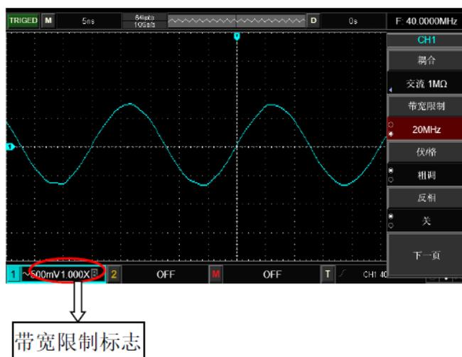
图 5-5 带宽限制打开时的波形显示
