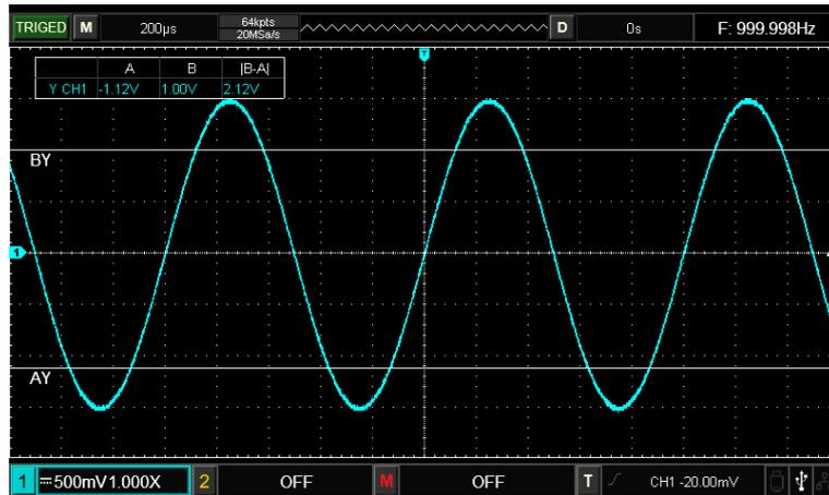
图 11-3 光标电压测量
