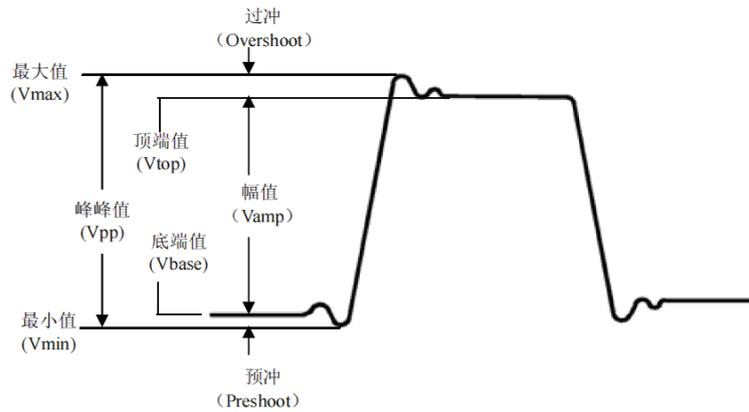
图 10-2 电压参数示意图
