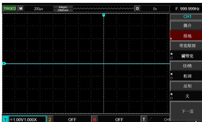
图 5-3 接地耦合时信号的直流分量和交流分量同时被阻隔
