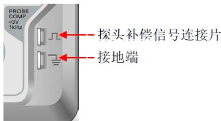
图 4-1 探头补偿信号连接片和接地端
