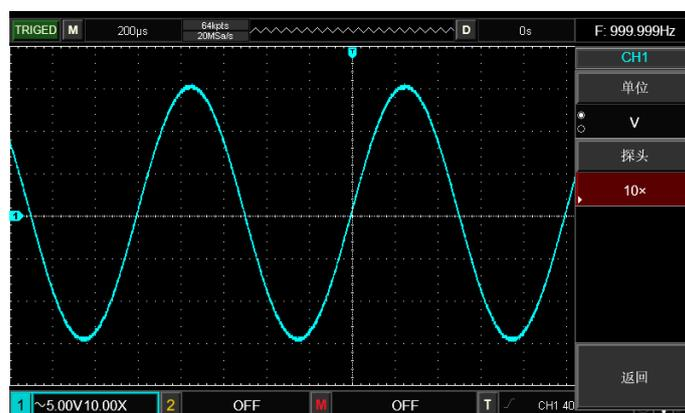
图 5-6 通道菜单中的探头衰减系数设定
