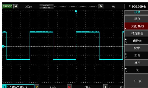
图 5-1 交流耦合时信号的直流分量被阻隔
