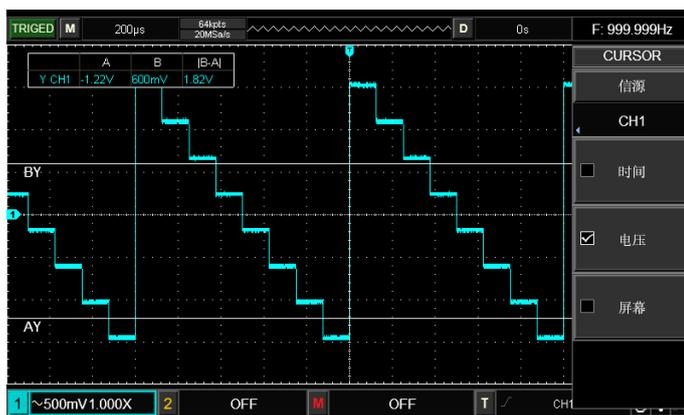
图 12-6 光标测量信号电压差
