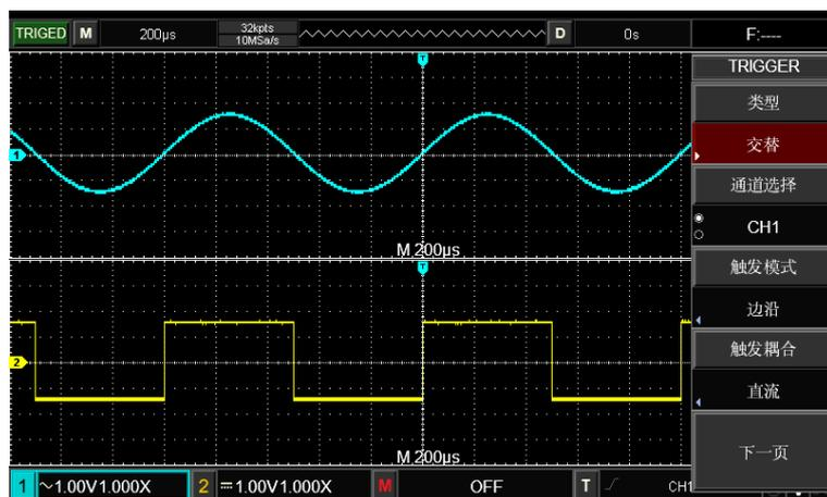
图 7-3 交替触发方式观察二个不相关的信号
